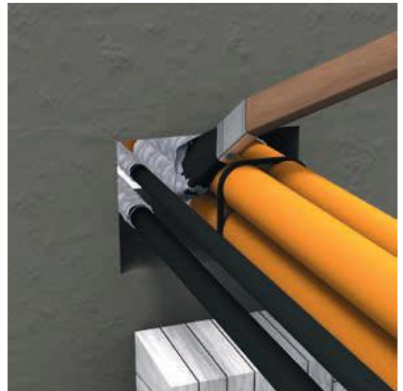
2. Kabel mit PYRO-SAFE FLAMMOPLAST KS 3 oder SIBRALIT DX auf einer Länge von mindestens 16 cm beschichten. Alternativ: Kabelwickel s. Seite 9
